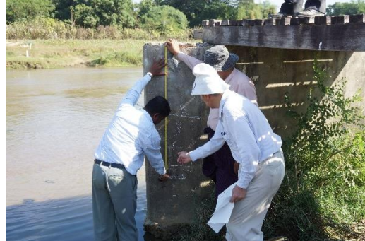
写真-4 a) 村人も入って現地測量 b) 水位痕跡なども参考に高さを決定
