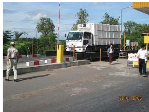
写真—8 車重計で大型車の重量を測っているところ
