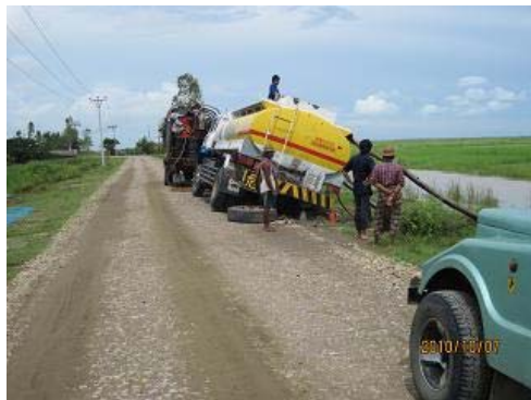
写真-36 バスとすれ違うために拡幅された路肩によったタンクローリーの車輪が埋まり、救助作業をしているところ。
