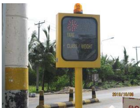
写真—10 車両の重量が表示板に表示され、重さによって料金が決定される。
