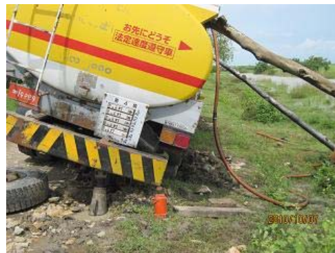
写真-36 バスとすれ違うために拡幅された路肩によったタンクローリーの車輪が埋まり、救助作業をしているところ。
